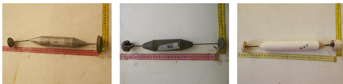
Figuras 1 (a), (b) e (c): O areômetro em 3 versões diferentes encontradas. Os registros fotográficos foram feitos sem que ainda soubéssemos do que se tratava. (Fonte: os autores)
