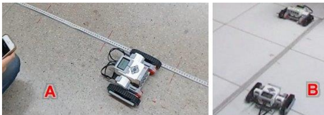
Figura 1: Detalhe do robô se deslocando para determinação da velocidade (A) e situação experimental em movimentos opostos (B)
