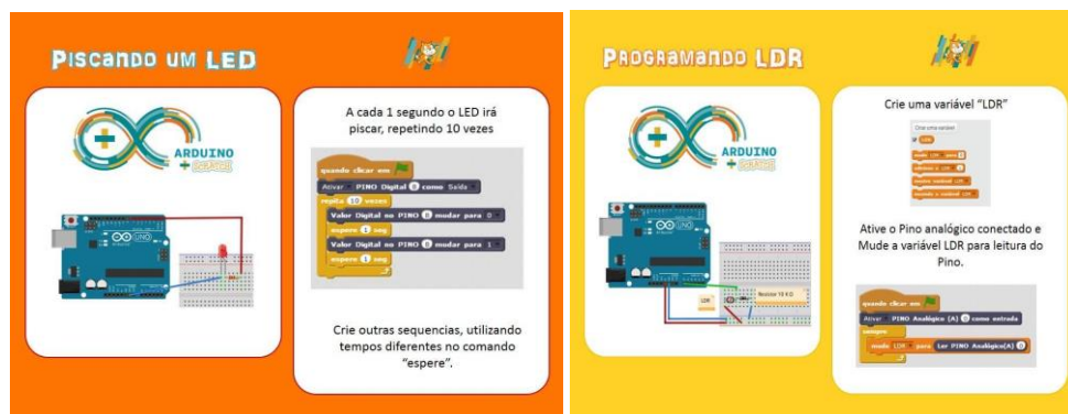
Figura 4. Fichas do Scratch confeccionadas como tutorial para conexão do LED e LDR no Arduino e programação no Scratch 2.0 offline.
