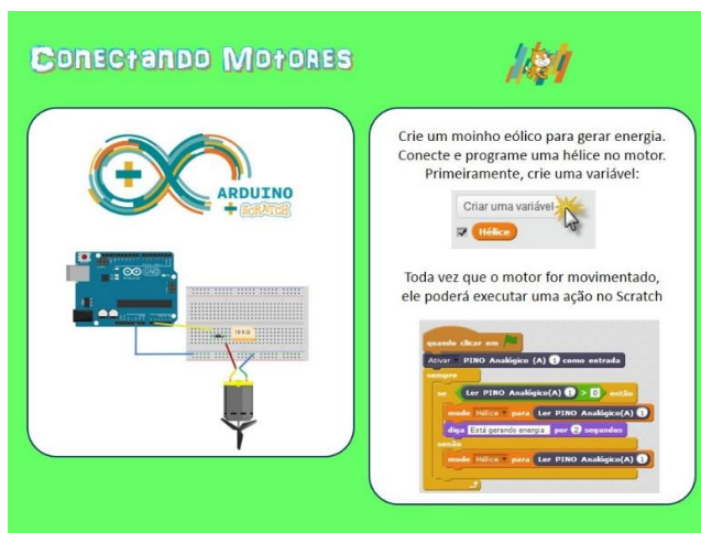
Figura 5. Ficha para ligação e programação do motor com hélice de energia eólica
