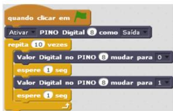
Figura 2: Programação para piscar o LED criada no Scratch 2.0 offline.
