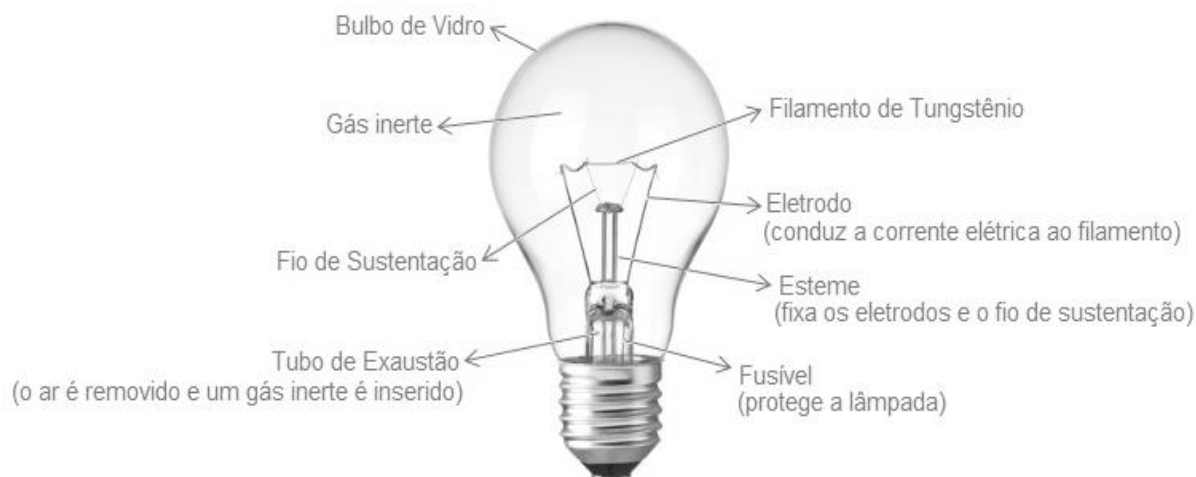
Figura 01: Componentes da Lâmpada Incandescente. Fonte: Adaptada de http://alunosonline.uol.com.br/fisica/lampadas-fluorescentes-incandescentes.html
