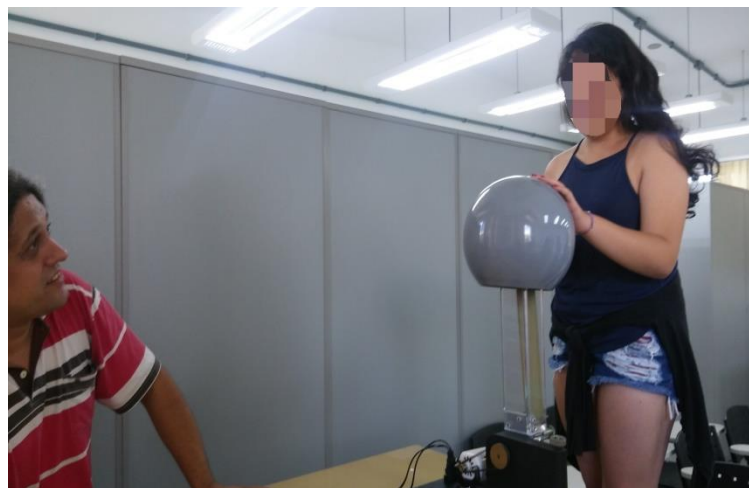
Figura 14: Experiência com o gerador de Van de Graaf
