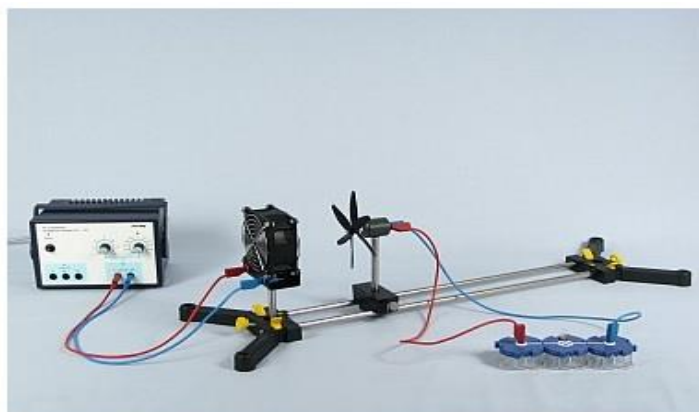
Figura 12: Experimento realizado pelos alunos do curso de Bacharelado em Ciência e Tecnologia que montaram uma maquete de como funciona a energia eólica.
