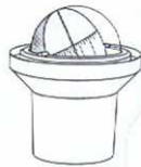
Figura 15(e). Relógio solar esférico auto-orientado (com bússola e esfera que flutua livremente sobre água do copo cilíndrico)
