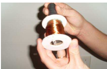
Movimento do ímã no interior das espiras acendendo o led.
