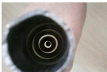
FIGURA 02: Ímã em formato esférico em queda vertical no interior do tubo de alumínio (fotografado de cima).
