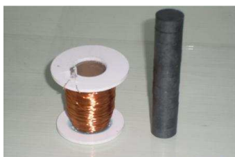
Bobina de 1000 espiras de cobre ligadas a um led.
