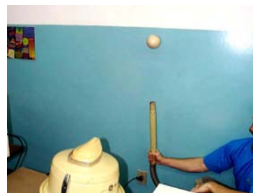
Figura 4 (Experiência com a bolina de isopor e fluxo de ar)
