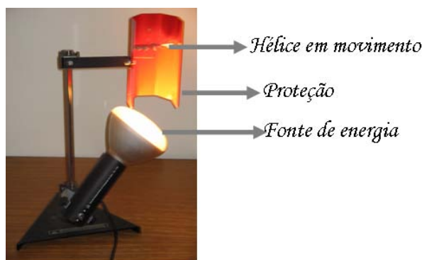
Figura 1: Experimento mostrando que o fluxo de energia por meio da lâmpada origina trabalho mecânico na hélice.
