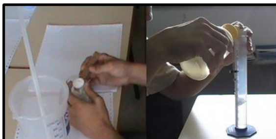
Figura 2: Espátula e proveta adaptadas.
