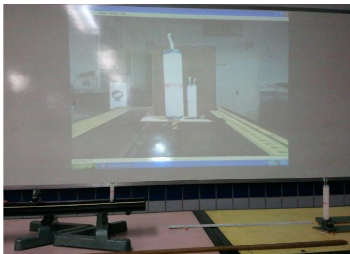
Figura 2: Na parte inferior da foto, vemos a vela da esquerda (“vela-objeto”) e a vela a direita (“vela-imagem”). A “vela-imagem” tem o dobro da altura e da largura da “vela-objeto”, como previsto pela equação do aumento linear transversal para os parâmetros usados na experiência. Porém, a “vela-imagem” (em segundo plano na projeção da parede) é visualizada com a metade da altura e da largura da “vela-objeto” (em primeiro plano na projeção da parede). Isso ocorre devido ao efeito do ângulo visual.
