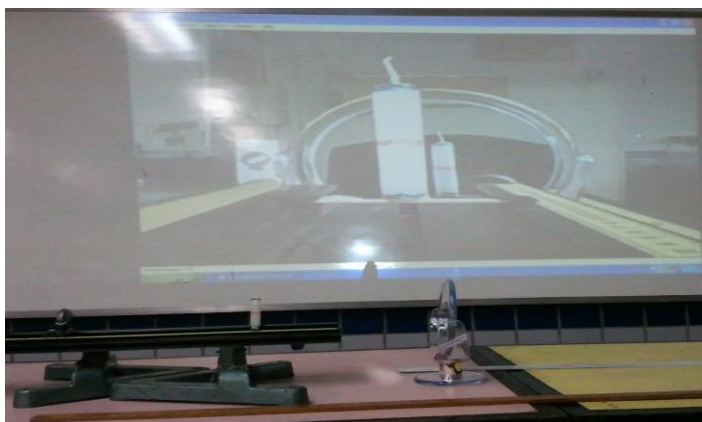
Figura 1: Na parte inferior da foto, a vela (objeto) está colocada entre o vértice e o foco do espelho, na posição p = 25 cm. A webcam (observador) está sobre o eixo principal na posição x = 50 cm. O aumento linear transversal (AL) da imagem vale 2. Porém, percebe-se que a imagem (em segundo plano na projeção na parede) é duas vezes menor do que o objeto (em primeiro plano na projeção na parede).
