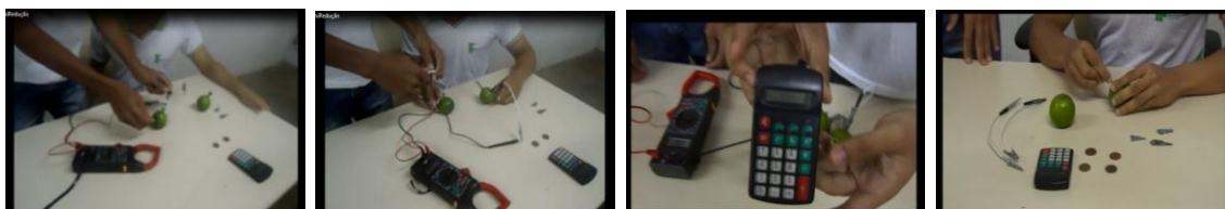
Figura 3: Pilha construída com limão para o funcionamento de uma calculadora.
